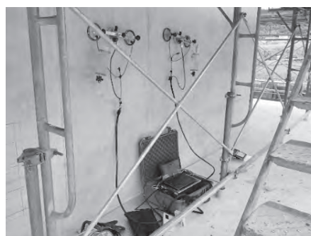
図-12 表面吸水試験（SWAT）
