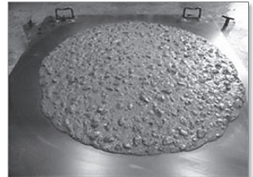
高流動コンクリート
