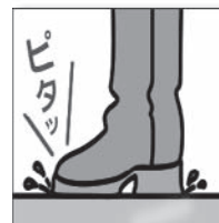
柔らかいゴムを使った靴底は、路面に対する密着力が強いため滑りにくくなっています。
