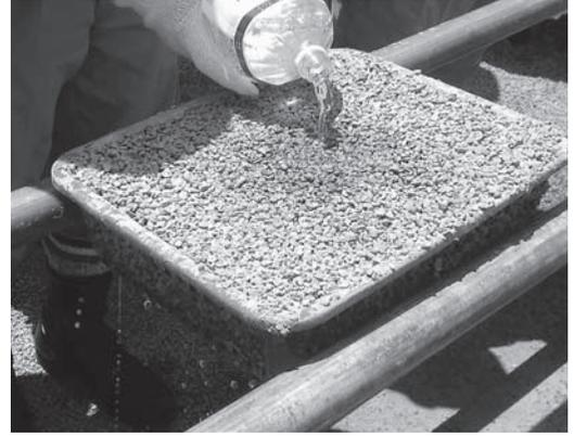
図-8 透水性コンクリート供試体
