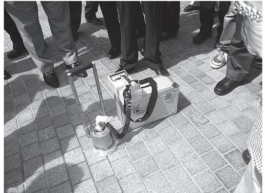
放射性汚染計測装置
