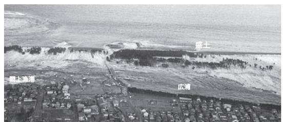
写真-5 津波襲来時の盛土（3/11）：海上保安庁／時事通信社による
