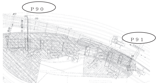
図-3 作業ヤード内桁組立要領図
