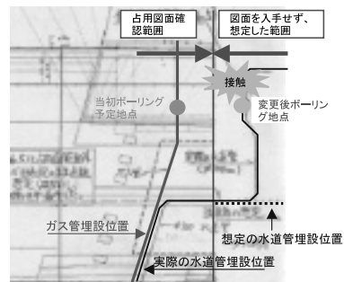
図－４ 事故発生状況
