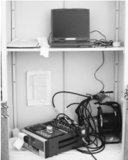
写真-1 データロガーを用いた計測状況
