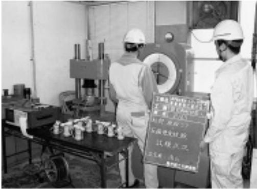
写真-4 採取コアの圧縮強度、ヤング係数測定試験
