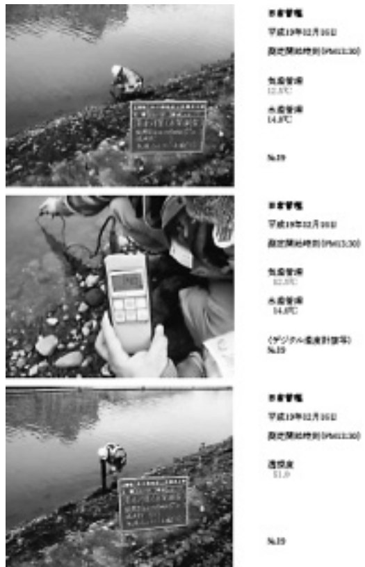
写真-6 日常管理状況 (デジタル温度計・透視度計使用)
