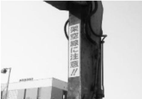
写真-3 架空線切断事故防止対策事例
