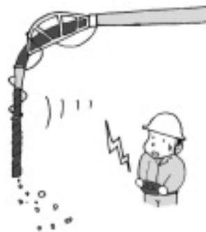
図2 吊り下げたホースからの骨材の落下
